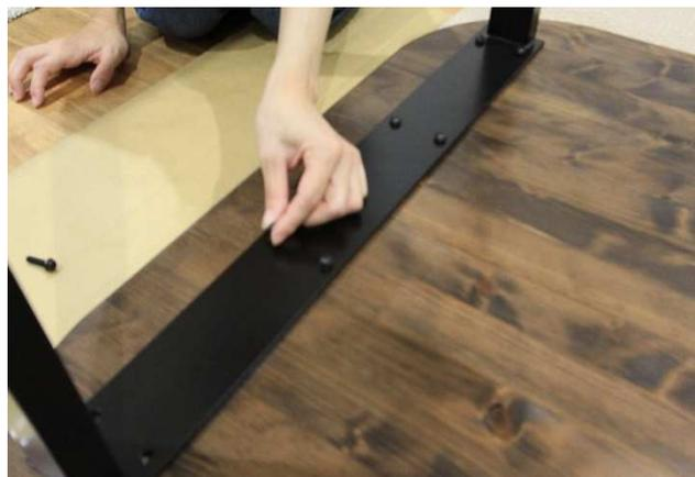
ネジ穴に、付属の固定用ネジをネジ用ワッシャーに通して差し込みます。
