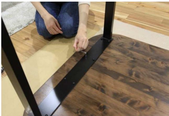
仮取り付けしたネジ穴に付属の六角レンチをさし軽く回せるところまでネジを締めてください。
