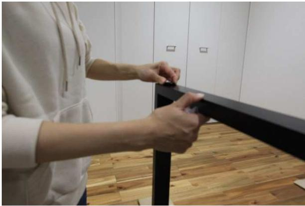
仮締めしたネジを外側から順にしっかり締め、本締めを行い、鉄脚を天板に固定します。
